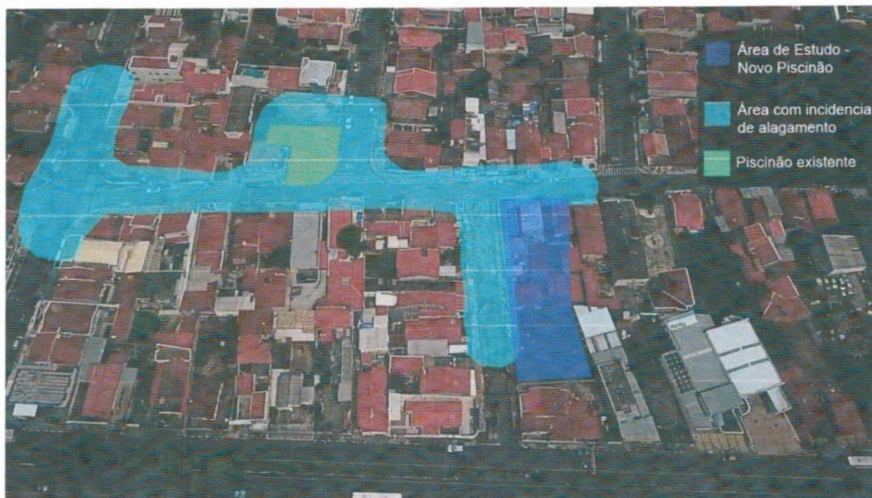
Figura 17: Área com alta incidência de alagamentos, devido à falta de escoamento e a concentração do direcionamento das águas pluviais das ruas do entorno.
