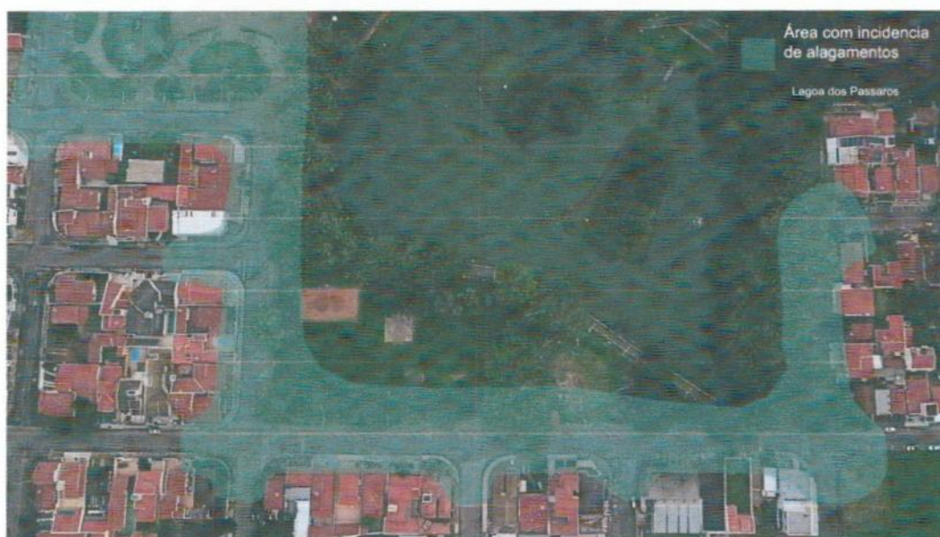
Figuras 09 e 10: Área no entorno da Lagoa dos Pássaros, demarcada como área de constante alagamento, devido à subida do nível da lagoa nos períodos chuvosos e falta de escoamento das ruas do entorno.
